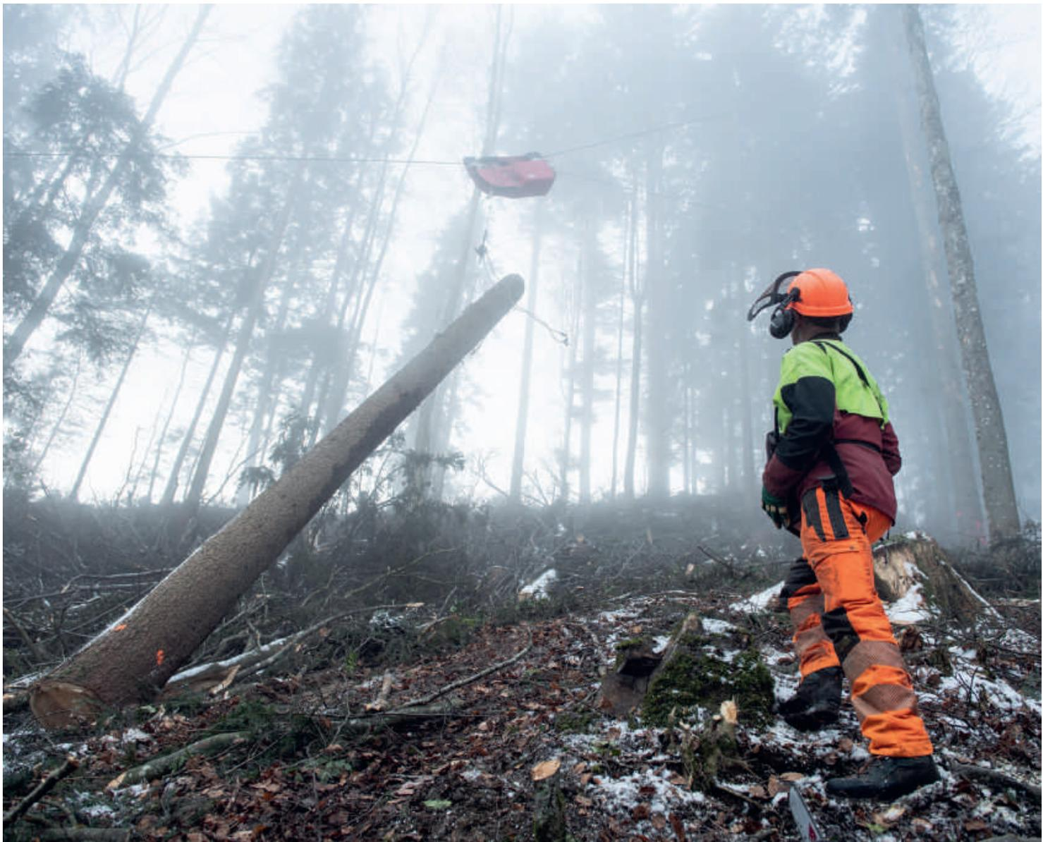
Über ein besonders belastbares Zugseil werden die gefällten Baumstämme Meter für Meter den Hang hoch befördert. Bis zu vier Tonnen schwere Stämme zieht die Konstruktion in einer Fuhr.
